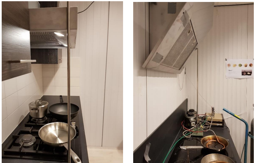
Figuur 6 links T-shape met 95% bedekking van de voorste branders, rechts schuine afzuigkap met 0% bedekking van voorbranders
